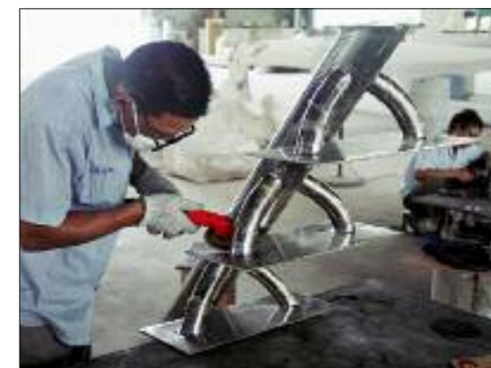
Les ouvriers de l'atelier inox réalisent eux-mêmes la plupart des pièces métal du trawler. Ici, une échelle intérieure de fly-bridge en cours de finition.
