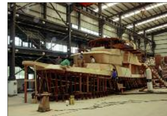
Le gabarit qui va permettre de fabriquer le moule du pont supérieur est réalisé en mousse et contreplaqué.
